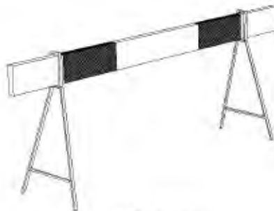
Valla de obras
