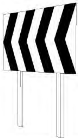
Valla de desviación de tráfico
